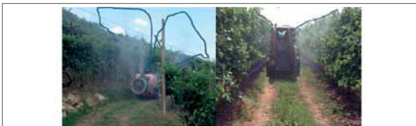
Figura 13 Confronto tra la dispersione della nube di gocce erogata da un atomizzatore tradizionale rispetto a quello equipaggiato con il gruppo ventola
