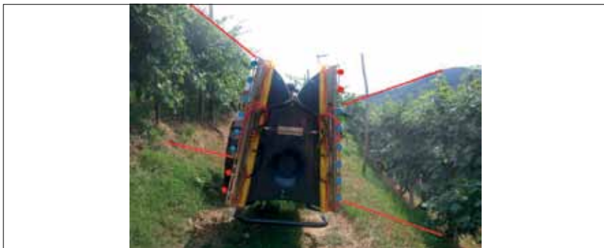
Figura 12 Azionamento elettroattuato di ugelli contrapposti per interventi su vigneti terrazzati
