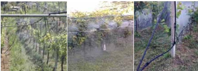
Figure 2-3-4 L'impianto fisso in funzione. Se gli ugelli sono ben orientati e liberi dalla vegetazione, la nebulizzazione ottenuta è simile a quella delle irroratrici e la bagnatura uniforme.
