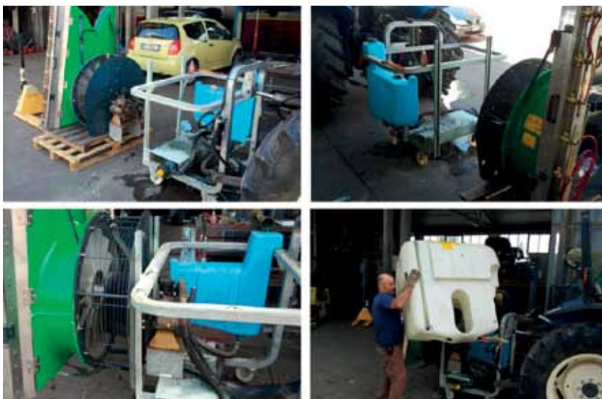
Figura 14 Fasi di sostituzione del ventilatore su un atomizzatore aziendale
